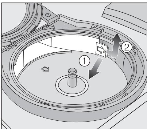
■ Разблокируйте канал дозирования в области клапана (стрелка) ① и вытяните его ②.
