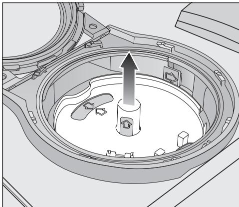
■ Потяните вверх держатель картриджа PowerDisk за области жёлтого цвета. При этом не тяните за боковой клапан.
