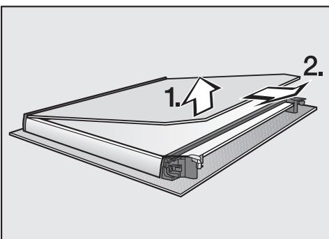
■ Слегка приподнимите внутреннее стекло дверцы и извлеките его из пластмассовой планки.
